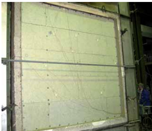
VTT polttokoekuva uunin ulkopuolelta
